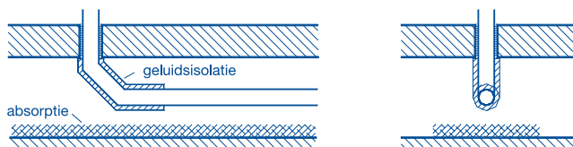
Afb. 4.5 Extra geluidsmaatregelen bij verlaagd plafond, geluidsisolatie + absorptie.
