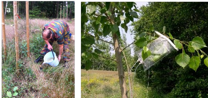
Figuur 6: a) Inoculeren van populier op een kerosine-verontreinigde site. b) Bemonsteren en meten van trichloroethyleen evapotranspiratie door populieren. Foto: Nele Weyens, Universiteit Hasselt.
