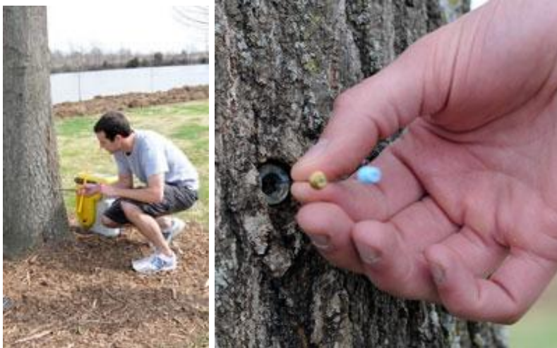
Figuur 25: Boring tot in sapstroom en SPME of SPS staalname. Bron: Joel Burken lab, Missouri S&T, USA.
