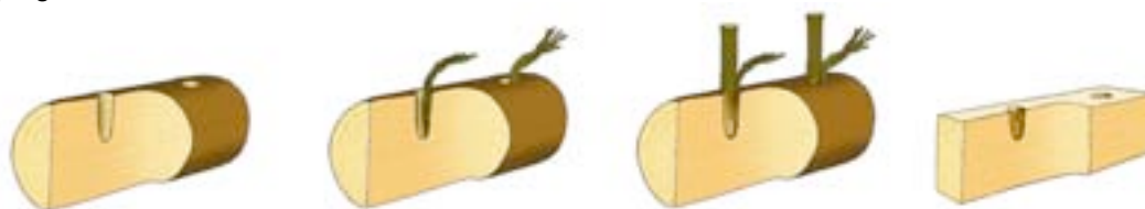
Wijze waarop wilgentenen en spie in het hout werden aangebracht (tekening Dik de Roon/ BMA).
