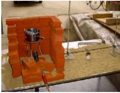
Fig. 65: Opstelling voor het smelten van lood.
