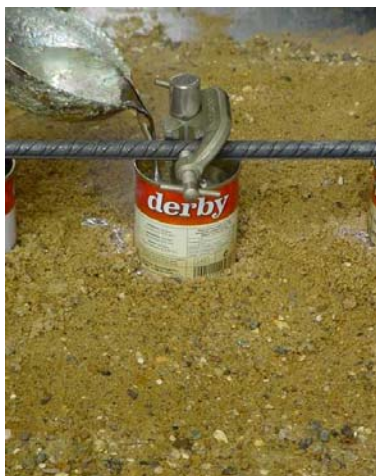
Fig. 68: Aangieten met lood van een ronde staaf.
