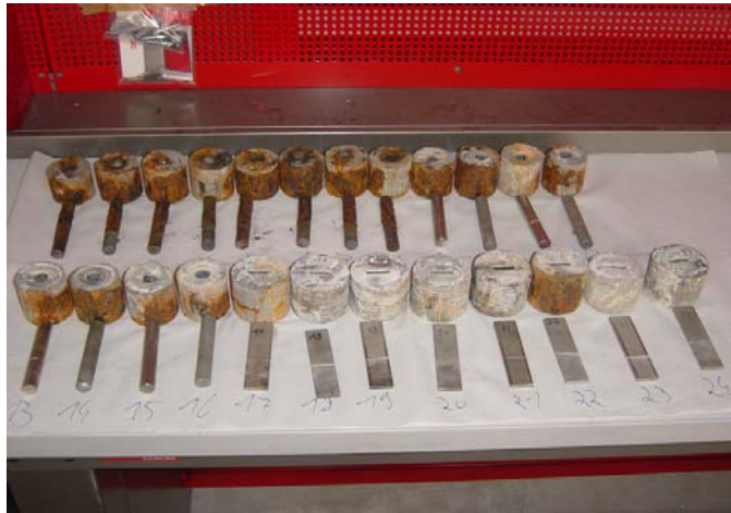
Fig. 78: De 24 proefstukken na hun verblijf van 266 uur in het zoutnevelkast en twee weken in de klimaatkast.
