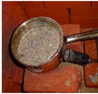
Fig. 66: Bovendrijven van afval tijdens het smelten.
