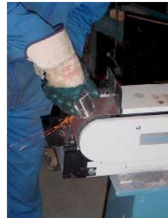
Fig. 72: Afschuren van het gesmolten vertinde of verchromde blik.
