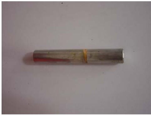
Fig. 80: Ronde, inoxen staaf. Materiaalophoping ter hoogte van het scheidingsvlak bovenste en onderste helft van de staaf.
