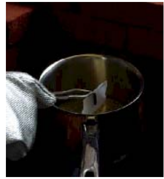
Fig. 67: Testen of het lood reeds gegoten kan worden.
