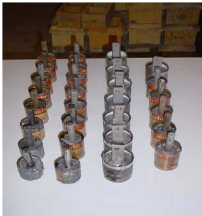
Fig. 70: De aangegoten en afgekoelde monsters.
