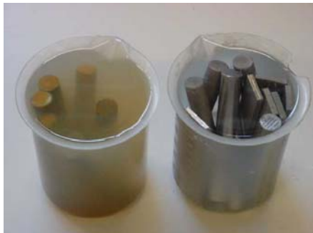
Fig. 60: De natte staven worden pas uit de beker gehaald nét voor het aangieten.
