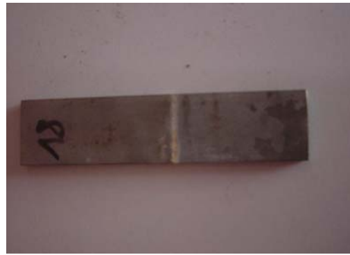
Fig. 81: Inoxen staaf met rechthoekige sectie. Materiaalophoping ter hoogte van het scheidingsvlak bovenste en onderste helft van de staaf.
