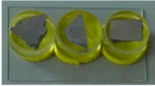
Fig. 41: Gepolijste monsters 'proefstuk 1600', 'proefstuk 1900' en 'proefstuk 2000-gegoten'.
