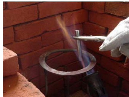
Fig. 61: De helft van de staven wordt gedroogd in de vlam van de gasbrander.
