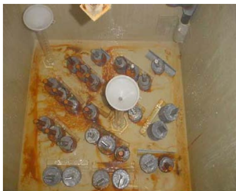
Fig. 76: Positionering van de proefmonsters. Deze foto werd genomen nadat de proefmonsters 266 uur aan de zoutneveltest waren onderworpen.
