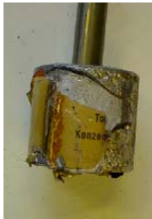
Fig. 71: Het blik blijft ‘plakken’ aan het lood.
