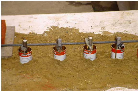
Fig. 64: Positionering van de staven in de lege conservenblikken.
