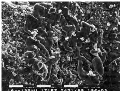
Figuur 31 REM-foto, die natriumzouten toont aan het oppervlak van de pleisterlaag. © TNO Bouw
