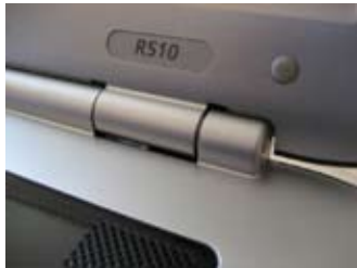
Boven: Onzichtbare scharnieren en een scharnier in het product geïntegreerd. Onder: Het vastzetten van twee elementen na het openklappen van de kubus.
