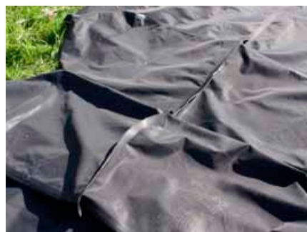
Let er op dat de lasnaad van de eerste SLAMDAM® aan de onderzijde gelijk loopt aan de volgende SLAMDAM®.
