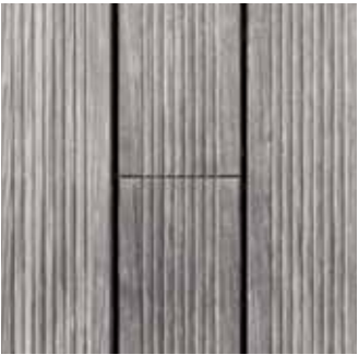
Gradaties van vergrijzing na installatie: Originele kleur (links), na 3 maanden verweren (midden) en na 18 maanden verweren zonder onderhoud (rechts).
