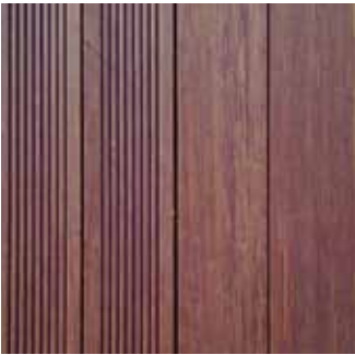
Oppervlakte van Bamboo X-treme bij verschillende onderhouds- en reinigingsscenario's: verweerd, vervuild oppervlak (links), verweerd, gereinigd oppervlak (midden) en oppervlak na reiniging en her-oliën (rechts).
