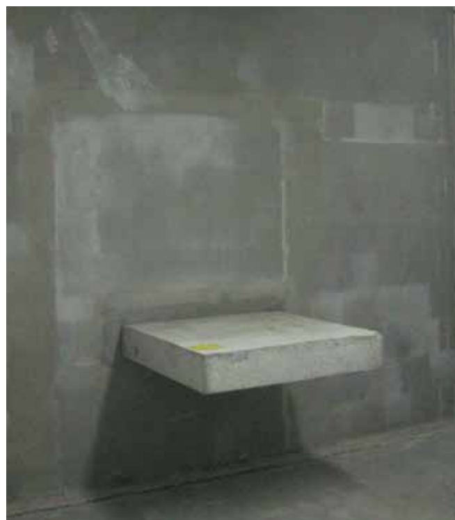
Proefopstelling volgens DIN EN ISO 10140 met ingebouwd element
