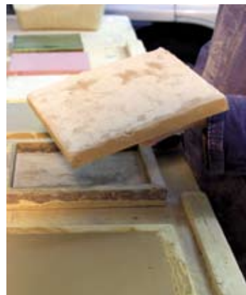
De gevormde estrik verlaat de mal
