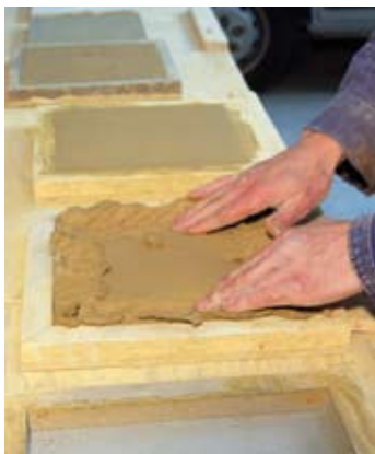
Vormen in de mal
