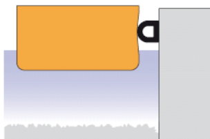
Fig. 3-9: Schematisering deformatie-coëfficiënt bij een 'hard' fendersysteem
