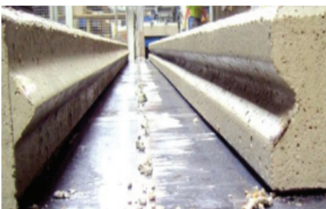
De visbek-/contravisbekverbinding damwandplanken
