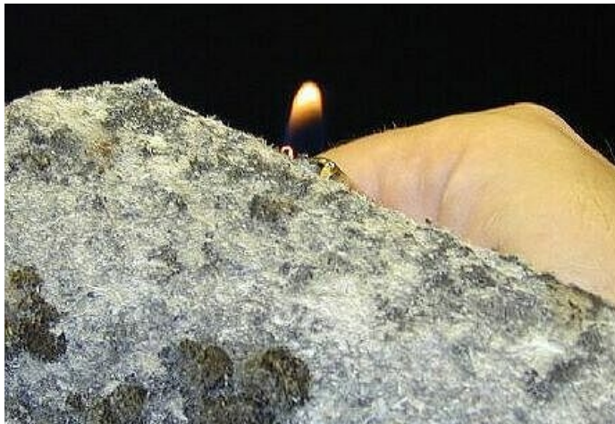
Figuur 7: opgloeiende asbestvezel
