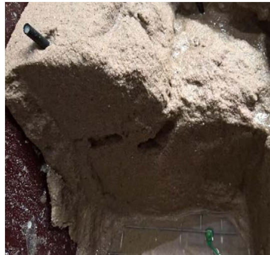
Figuur 35: Doorsnede injectielaag beproeving 5
