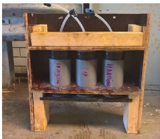
Figuur 22: Proefopstelling doorlatendheidsmetingen trilproef
