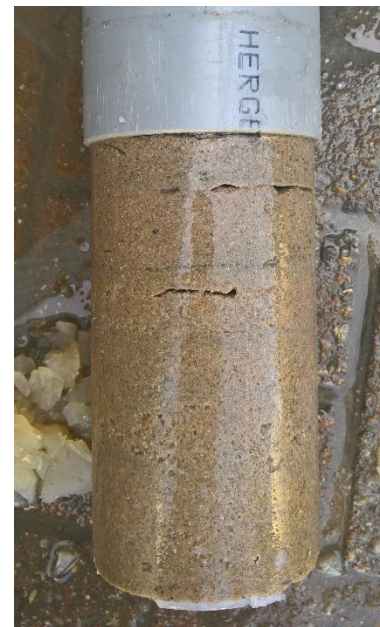
Figuur 21: Getrild na uitharden
