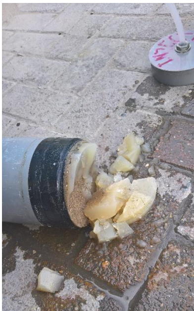
Figuur 19: Getrild tijdens injectie
