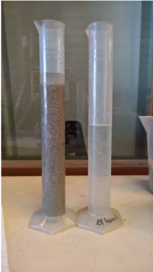
Figuur 2 Bepalen porievolume
