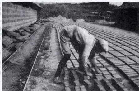
Het keren van de stenen die liggen te drogen
