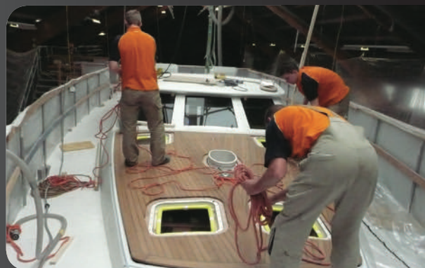
Voorbereiding plakken teakdek Van Dam Nordia Shipyard
