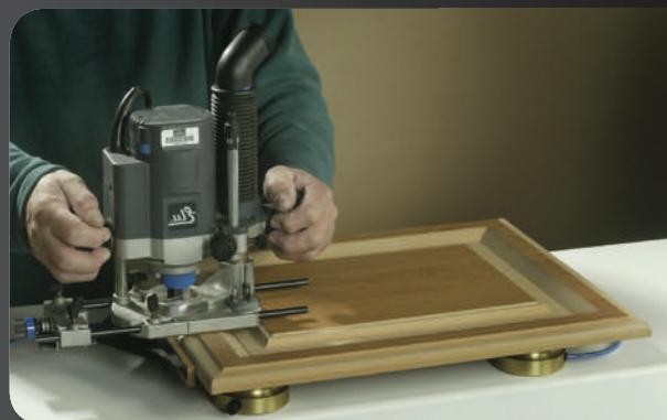
Opspannen werkstuk met behulp van vacuümklemmen
