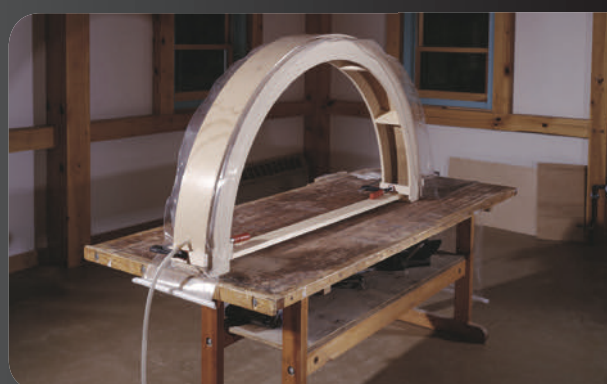
Gevormd over een mal buiten het vacuüm
