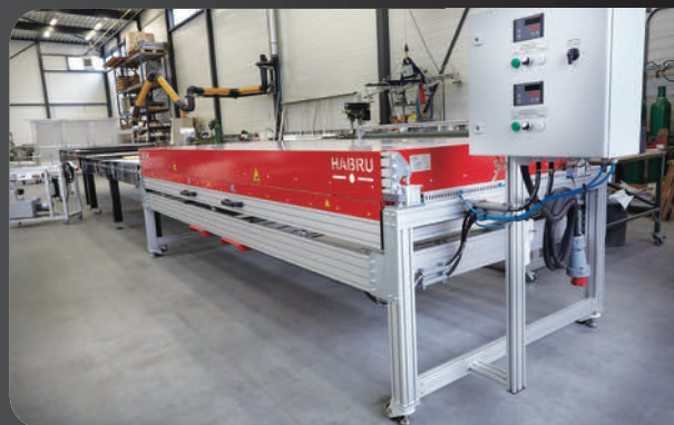
Separate unit met twee Elkom verwarmingsplaten
