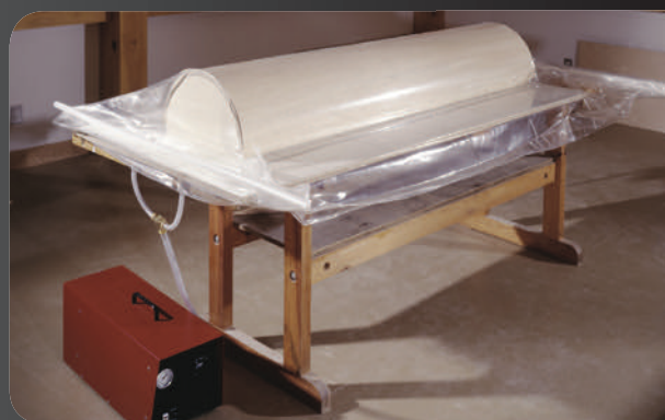
Gevormd over een mal binnen het vacuüm
