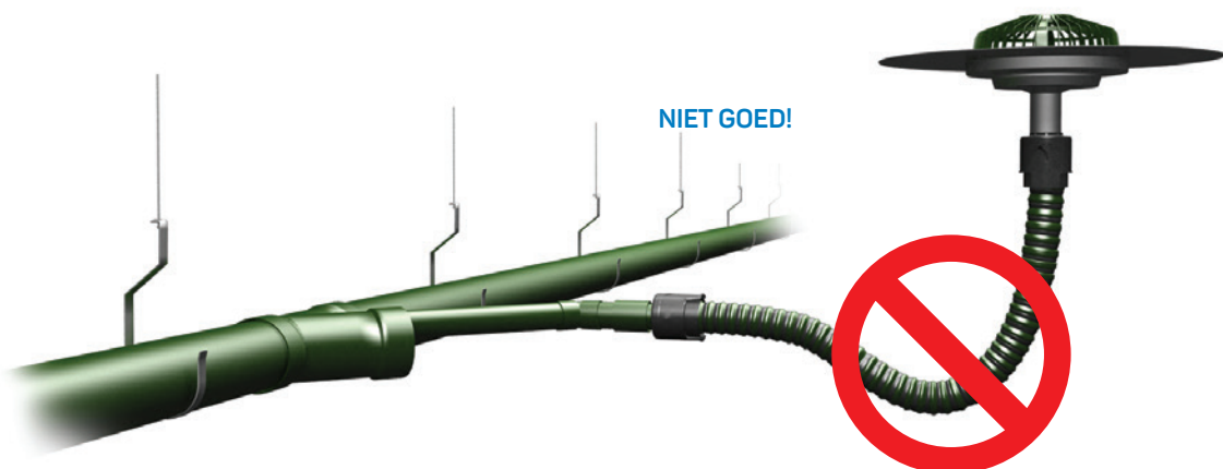
Figuur 6.2: slang mag niet doorhangen
