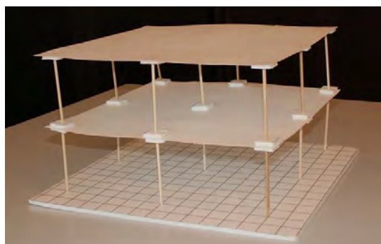
Figuur 5.1: Maquette met demontabele kolommen
