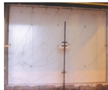
Frame conform NEN6069 met sandwichpanelen
