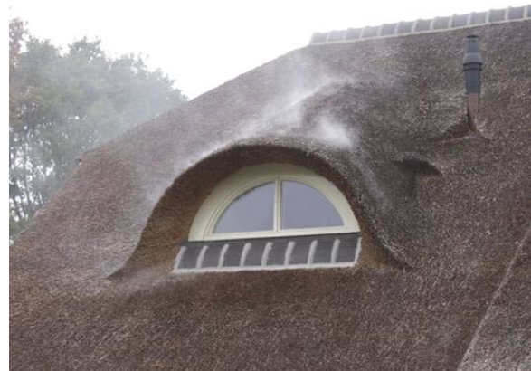
Een Blowerdoor meting en onderzoek met rookdetectie; luchtlekken in de dakkapel worden zichtbaar. Bron foto 1: Adviesburo Nieman B.V. en foto 2: Emad Consultancies B.V.
