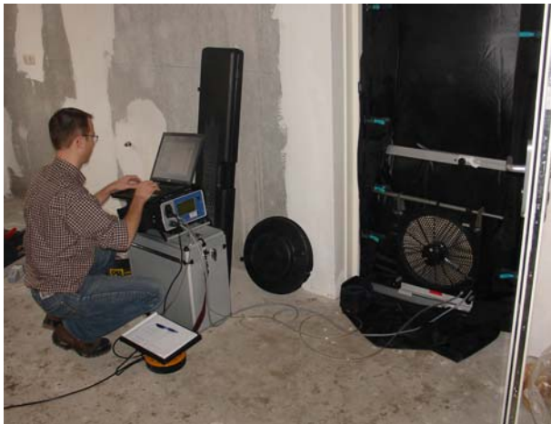
Een Blowerdoor meting en onderzoek met rookdetectie; luchtlekken in de dakkapel worden zichtbaar. Bron foto 1: Adviesburo Nieman B.V. en foto 2: Emad Consultancies B.V.
