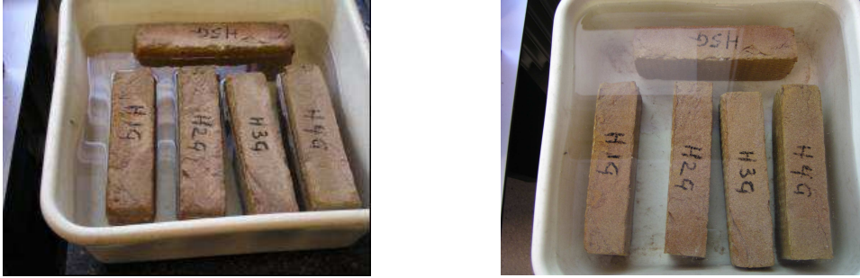
Figuur 2 Onderdompeling in twee fasen: eerst gedeeltelijk (links) zodat lucht uit het monster kan ontsnappen, vervolgens geheel (rechts)
