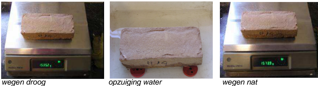
Figuur 1 Proefopstelling Hallergetalbepaling
