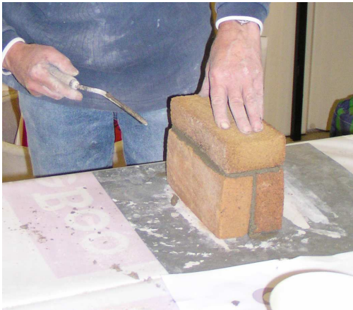
Vervaardiging T-Vormig proefstuk
