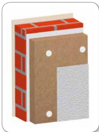
Bepleisterde gevel één laag
