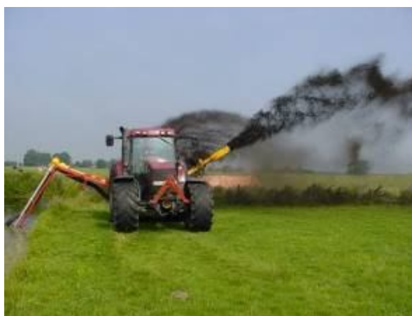
Baggeren van de waterbodem
