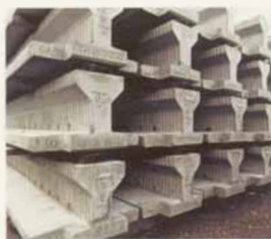
Bild 16. Fertigbetonträger für den Tunnelüberbau Fig. 16. Application of precast beams for the tunneldeck Fig. 16. Poutre en béton préfabriqué pour superstructure de tunnel
