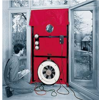
BLOWERDOOR luchtdichtingsmeting kwantitatief bepaling van de n_{50} -waarde van de gebouwschil
