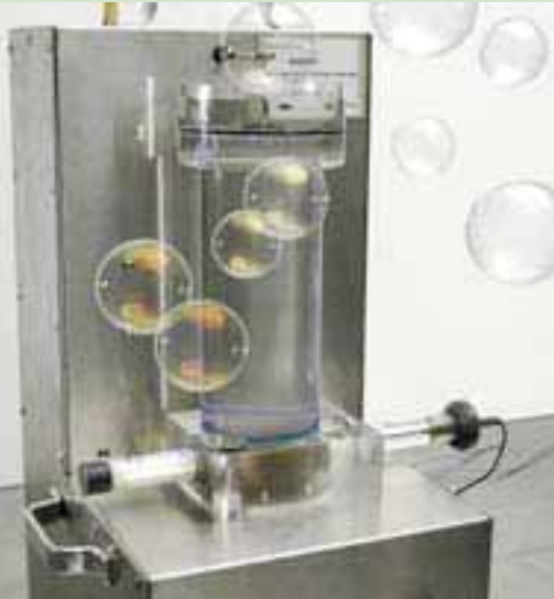
'Air Void Analyser' meet de hoeveelheid grote en kleine luchtbellen in betonspecie
