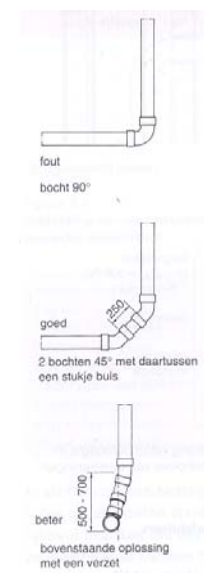
Afbeelding 9: Uitvoering standleidingvoet
