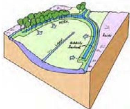
Afb. 11.11 Opgeleide beek bovenop houtwallen; Vennevertlose beek, Achterhoek.
