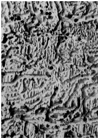
Afbeelding: inwendige aantasting door de gewone houtwormkever.
