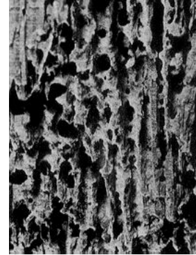
Afbeelding: het inwendige van het door de grote van de grote houtwormkever. houtwormkever sterk aangetaste hout.
