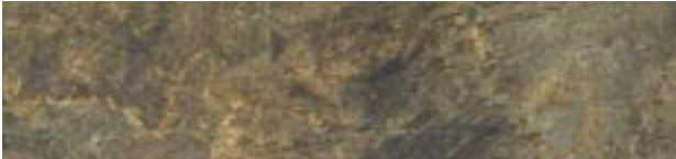
Gekloofde breuksteen (schaal 1:1)
