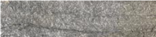
Gekloofde breuksteen (schaal 1:1)
