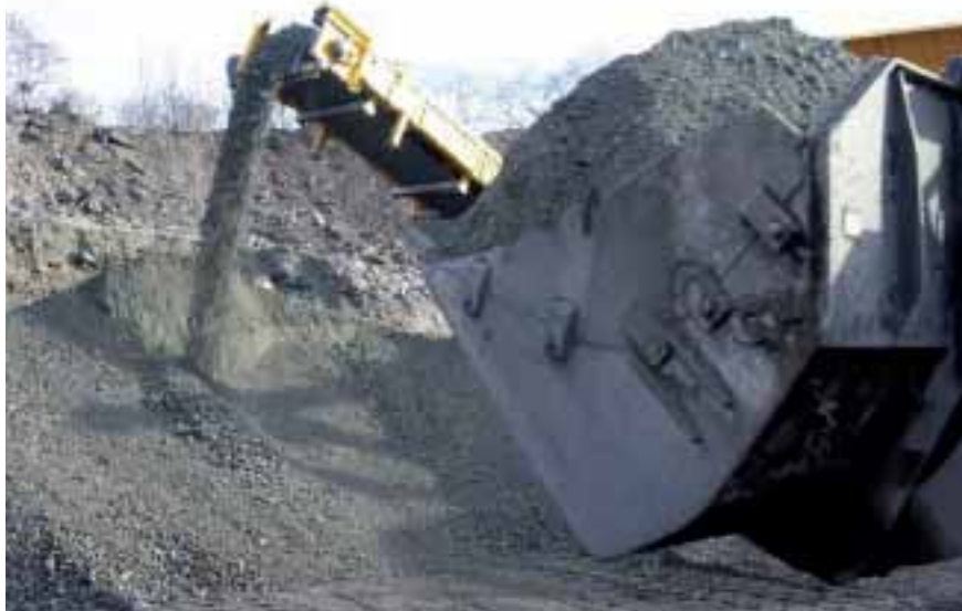
Restanten van betonconstructies of producten worden gebroken, daarna behandeld tot bruikbare grondstof en op korrelgrootte gesorteerd
