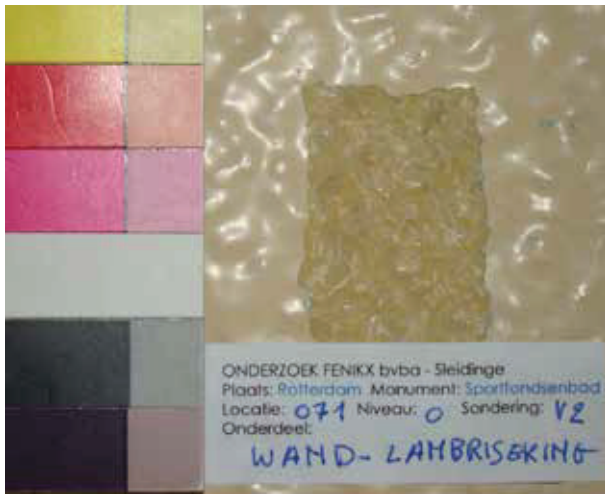
Fortoliet teinté en masse. Sportfondsenbad Rotterdam, 1937 In de massa gekleurde fortoliet. Sportfondsenbad in Rotterdam, 1937 (Photo/ foto : A. Verdonck - Fenikx bvba)
