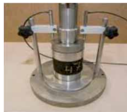
Triaxiaalproef: bepaling weerstand tegen spoor- en ribbelvorming.
