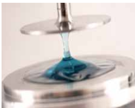
Bepaling rheologie (stijfheid en flexibiliteit van bitumen in bepaalde temperatuurfase) en viscositeit (omhulbaarheid en verwerkbaarheid van bitumen bij temperatuurfase).
