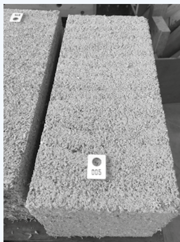
Genummerd kalkhennepblok, klaar om te testen.
